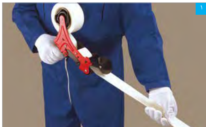
خم کردن نوار درزگیر با دستگاه تازن
