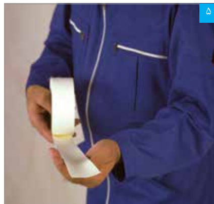
مقطع نوار درزگیر (به انحنای آن توجه شود)
